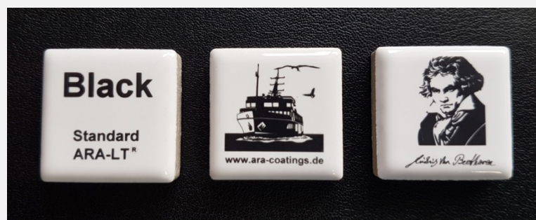
Foto: Auf Keramikoberflächen gelaserte Motive
