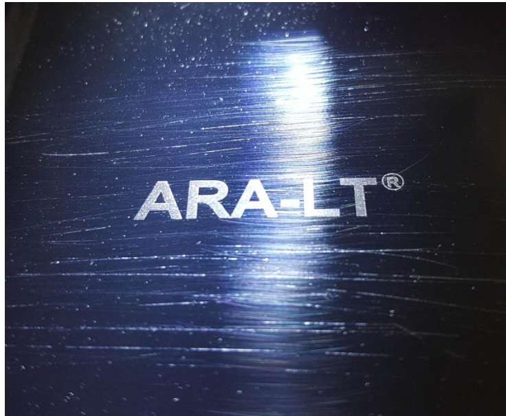
Abb. 1: Erfolgreicher Versuch, eine ARA-LT®-Beschriftung mit Stahlwolle von einer emaillierten Oberfläche zu entfernen oder zumindest zu beschädigen
