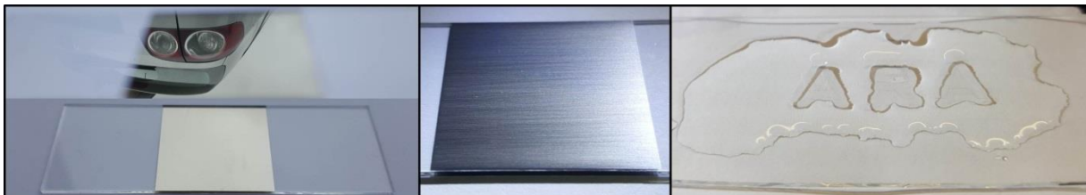
Abb. 3: Aufgelaserte, spiegelnde Silberschicht (links), gebürstete Stahlschicht (Mitte) und transparente, super-hydrophobe und robuste Easy-to-Clean-Beschriftung (rechts)
